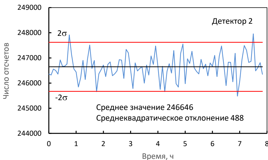
Рис. 12. Изменение площади пика с энергией 185,7 кэВ за 8 часов непрерывной работы для детектора 2
